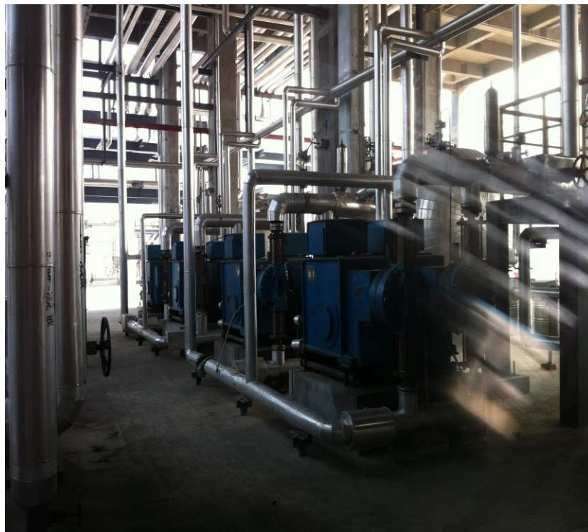
组图二 为 5 万吨/年规模碳酸二甲酯配套 6 万吨/年碳酸丙烯酯装置
