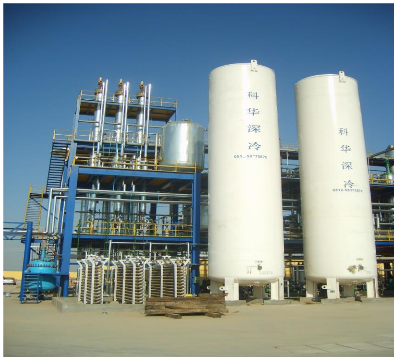
组图一 为 2 万吨/年规模碳酸二甲酯配套 3 万吨/年碳酸丙烯酯装置
